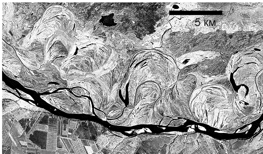
Рис. 3 Трансформация русла верхней Оби с односторонней поймой из крутотеандрирующего с малыми излучинами в пологотеандрирующее с большими излучинами и побочнями. По А.В. Чернову и Л.М. Гаррисон (1981) это событие произошло около 3000 лет назад.
