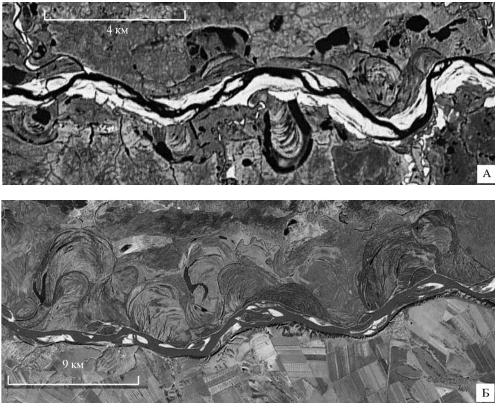
Рис. 3. Трансформация русла из крутотеандрирующего с малыми излучинами в пологотеандрирующее с большими излучинами и побочными на участках: А – с двухсторонней поймой (р. Хадутгэ, приток нижнего Пура) и Б – с односторонней поймой (верхняя Обь; по А.В. Чернову и Л.М. Гаррисон [24], это событие произошло около 3000 л. н.)
