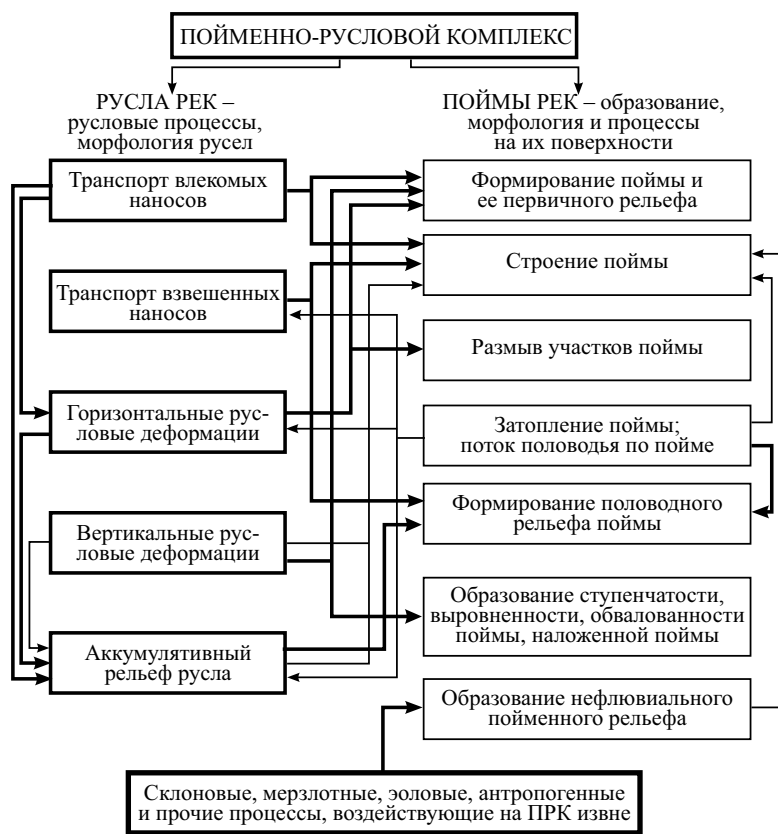
Рис. 4.69. Структура пойменно-руслового комплекса и происходящие в нем процессы. Толщина стрелок указывает на значимость связей
