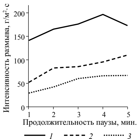
Рис. 2.9. Зависимость интенсивности размыва модельного образца почвы в зависимости от продолжительности пауз, в течение которых образец содержится в неподвижной воде, и длительности (15, 30 и 60 с) активной фазы
