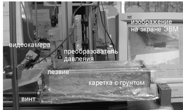
Размер каретки с образцом грунта составляет 250\*100\*100 мм. Длина каждого разреза 227-228 мм, по ширине каретки можно последовательно расположить 8-10 разрезов. По толщине образца грунта, снимая последовательно отработанные слои, оказалось возможным опробовать три-четыре слоя для получения трехмерной картины
